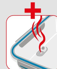
Dampfventil im Deckel (wiederverschließbar)
