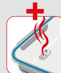
Dampfventil im Deckel (wiederverschließbar)
